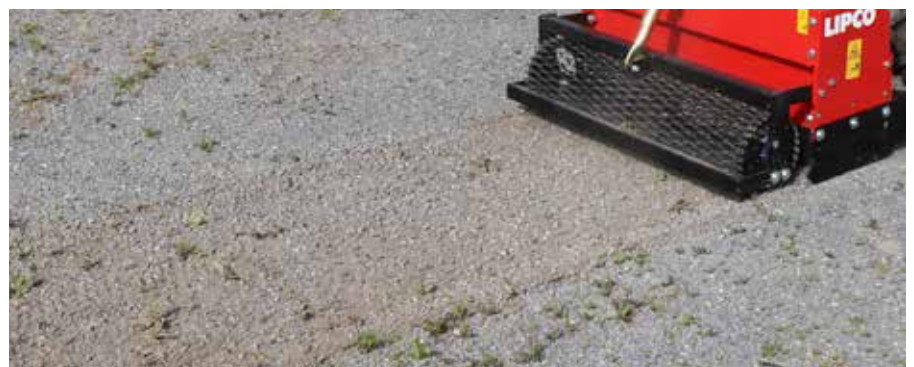
Resultat: Ausgerissene Pflanzen liegen auf intakten Schichten.
