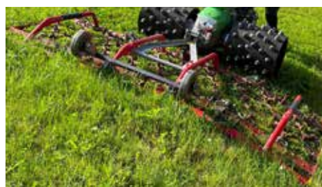
Bei der Ausführung mit mehrteiligem Rahmen ergeben sich weitere Eigenschaften. Während der Anwendung passen sich die einzelnen Rahmenabschnitte auch auf kupperten Flächen dem Gelände gut an.
