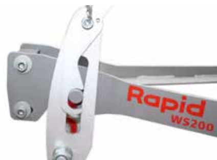
In Transport- oder Verladestellung, Wiesenschleppe fixiert
