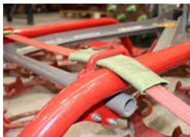
Anheben, Laden, Sichern Kran-Ösen und Laschen zum Einfädeln von Spanngurten ermöglichen einfaches Aufhängen und zuverlässige Ladungssicherung.
