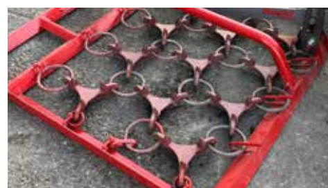
Sterne mit Stegen und Spitzen, beidseitig einsetzbar
