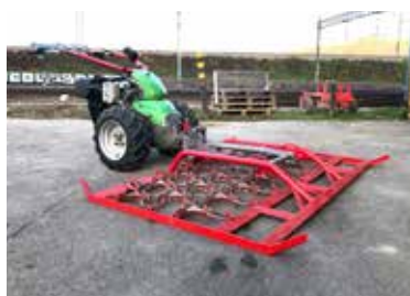
Gezogenes Anbaugerät Durch den konzeptionellen Aufbau der Wiesenschleppe wird bequem gestossen-gezogen in Vorwärtsrichtung gearbeitet werden.
