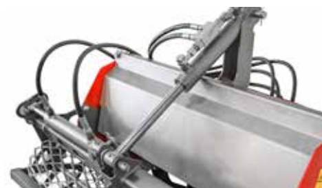
optionale Hydraulische Höhen- und Seitenverstellung der Nachlaufwalze
