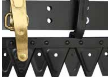
Breitspurmähwerk, System Bidux
