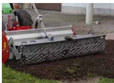
In einem Arbeitsgang Altrasen einfräsen
