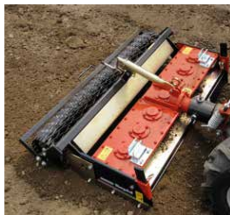
Stufenlose Einstellung der Arbeitstiefe mittels Handspindel
