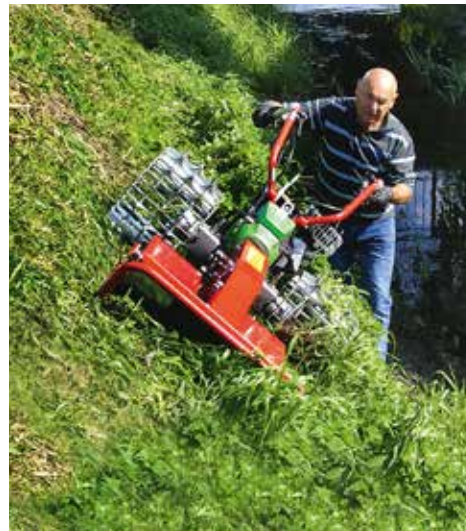
Robustes, 8 mm starkes Stahlmesser
