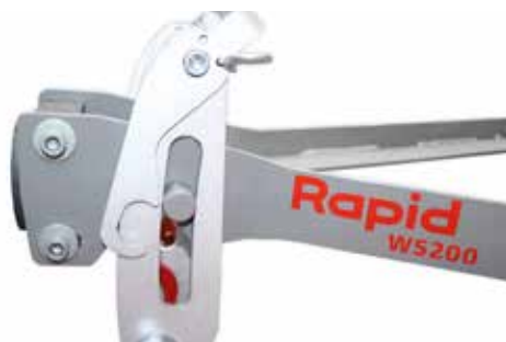
In Arbeitsstellung, Wiesenschleppe schwimmend
