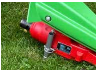
Abbaustütze zum einfachen An- und Abkuppeln
